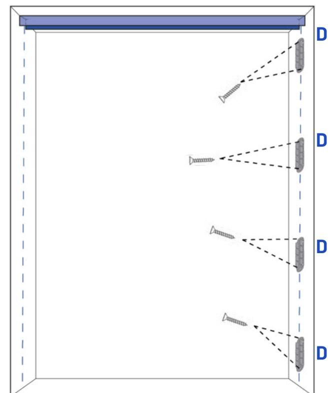
**5.** Sur le côté opposé, aligner verticalement les 4 autres plaques **(D)\*** et vérifier que celle-ci soit bien en face des autres. Puis, vissez et/ou collez les.
