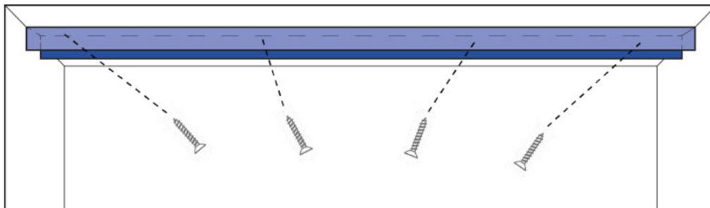
4. Aligner 4 plaques de fixations (D) à la verticale d'un côté et vérifier à l'aide d'un niveau. Percer, puis fixer les plaques au mur avec les vis et chevilles.
